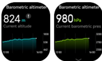
Los cambios meteorológicos pueden afectar a la presión barométrica, lo que puede afectar a la precisión de la medición de la altitud.
