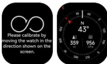
Prima dell'uso, indossare l'orologio al polso e seguire le istruzioni sullo schermo per la calibrazione, tenendolo lontano da interferenze elettromagnetiche.
