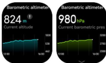
gio. I cambiamenti meteorologici possono influenzare la pressione barometrica, il che può influire sulla precisione della misurazione dell'altitudine.
